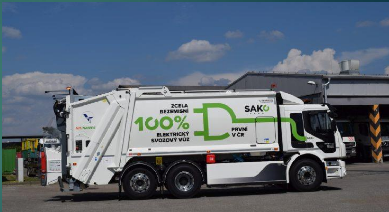
Volvo FE Electric v úpravě pro svoz odpadu. foto: SAKO
